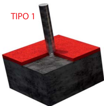
FIJACION A SOLERA DE HORMIGON
