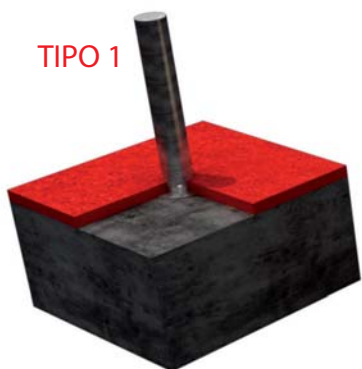
FIJACION A SOLERA DE HORMIGON
