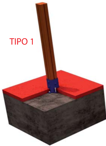
FIJACION A SOLERA DE HORMIGON
